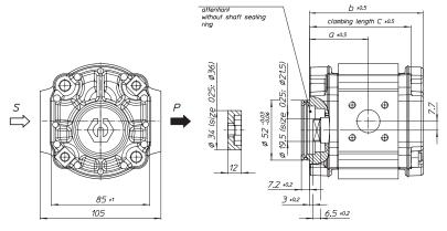
連軸器包括在交付範圍內。 提供帶DIN 433平墊圈的M8 DIN 912緊固螺釘,擰緊扭矩M = 25 + 5 Nm
