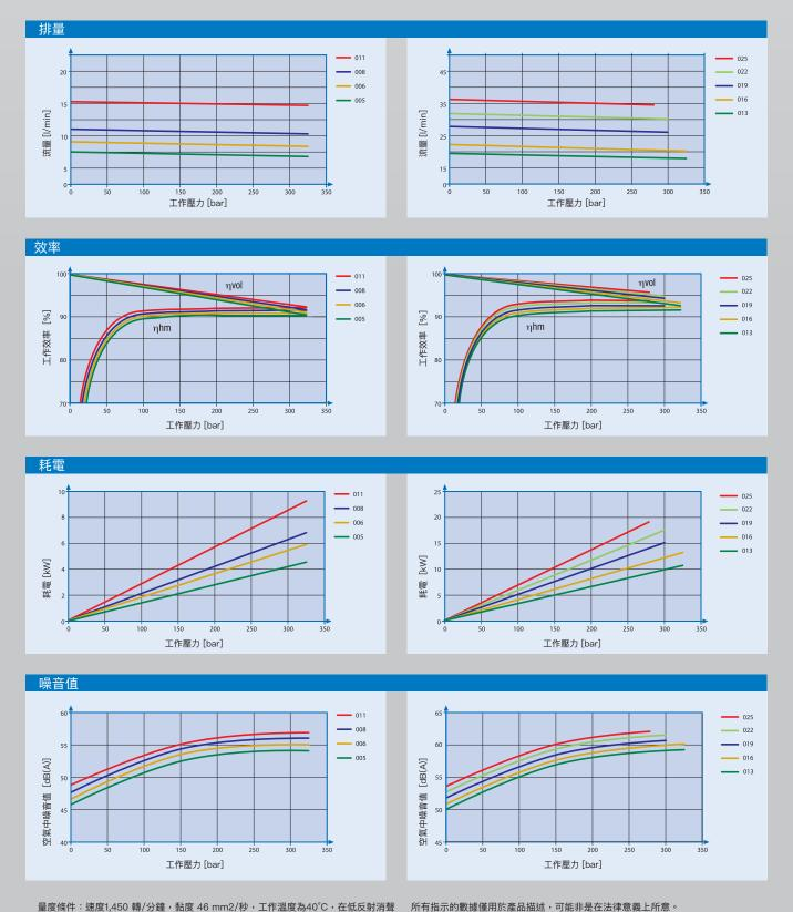
室測量聲壓,符合DIN 45 635表26; 麥克風距離1.0米。 如
